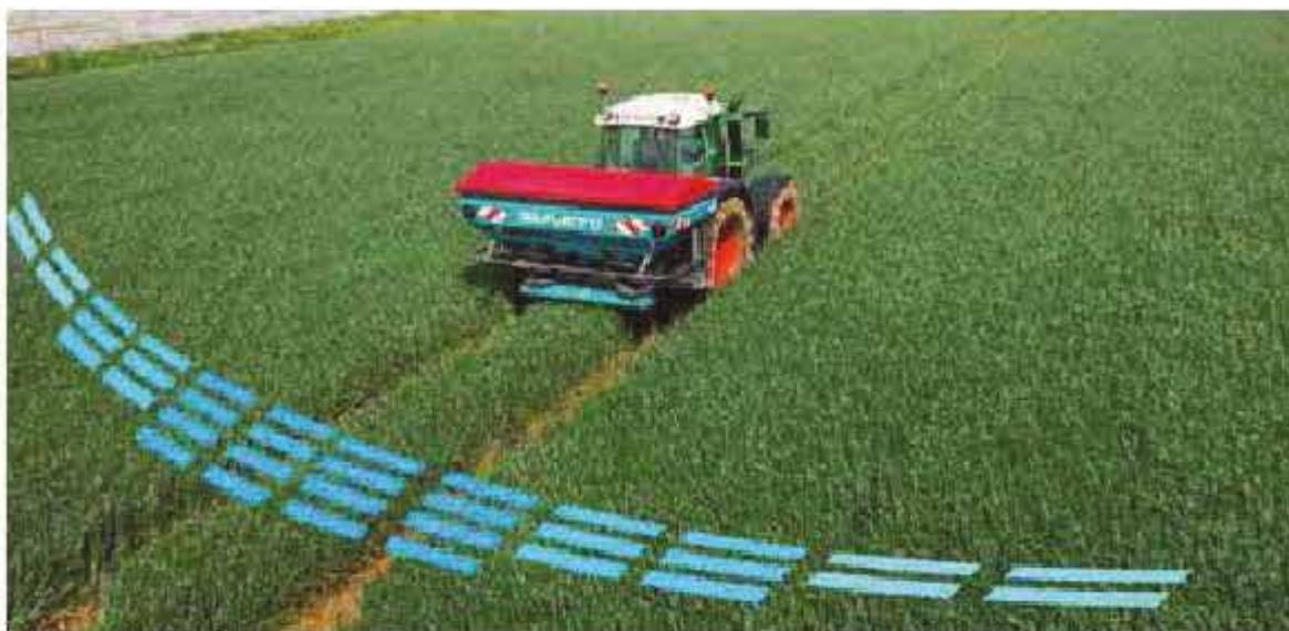
La fascia di spandimento non è rettilinea. L'analisi di questa fascia rileva una forma curva. L'innovazione ECONOV consiste nel gestire in tempo reale questa fascia in 12 settori e a pilotare ogni settore in modo indipendente.
